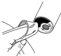
**ES** Limpiar el grifo solo con detergentes líquidos no ácidos. No utilizar ningún tipo de estropajo. Mantener limpio el visor cuidando de no rayarlo.
