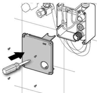
**ES** El grifo avisa de la necesidad de de reemplazar las pilas mediante destellos intermitentes del visor inferior cada vez que se utilice el grifo. Ud. dispondrá de varios días para realizar el cambio de pilas.
