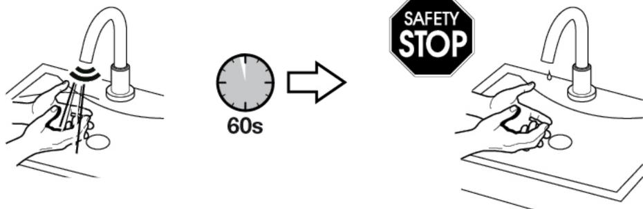
**ES** El flujo de agua se interrumpirá automáticamente pasados 60 segundos de su activación, como medida de seguridad, ante la invasión prolongada del campo de detección por parte de algún objeto. El grifo volverá a quedar operativo al retirar el objeto causante de la activación. El grifo incorpora además un sistema que asegura el cierre del paso de agua al quedarse sin alimentación eléctrica durante el uso del mismo.
