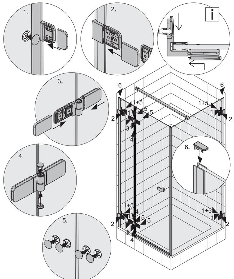
**RO** Fixați elementele de acoperire a șuruburilor de instalare a consolelor de susținere a ușii fixe și peretelui pe suprafața interioară și cea exterioară a cabinei de duș. Apoi, fixați elementele de acoperire a șuruburilor de instalare a balamalelor ușilor.
