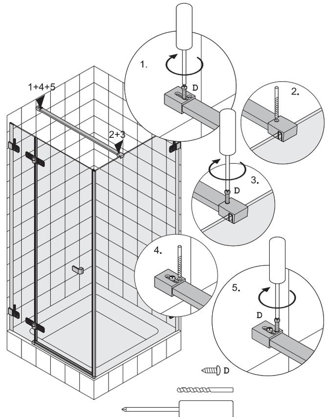
**SK** Upevnite profil ramena v montážnych prvkoch a za pomoci skrutiek D zablokujte profil v montážnom prvku na stene. V mieste otvorov montážnych prvkov, vyvrtajte otvory do profilu ramena a potom ho priskrutkujte skrutkami D.
