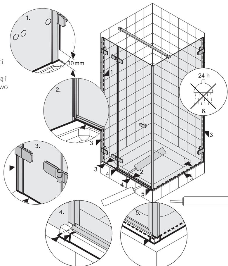
**RUS** С внутренней стороны кабины уплотните санитарным силиконом соединения нижних краев стенки двери, неподвижной стенки и нижнего профиля с поддоном. С внешней стороны кабины уплотните соединения боковых и нижних краев кабины со стеной и поддоном, а также нижнего профиля с поддоном. Дополнительно уплотните соединение нижнего профиля соединителями. После завершения монтажа кабиной нельзя пользоваться на протяжении 24 часов. Это время нужно для соответствующего затвердения силикона.
