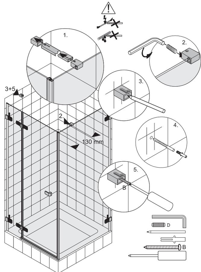
**RUS** Снимите опору, отделяя профиль от элементов крепления. Прикрутите элемент крепления опоры к стенке и кабине. Потом приложите настенный элемент крепления опоры к стене и отметьте место сверления монтажного отверстия. Высверлите в стене отверстие, диаметром 6 мм, вставьте в него распорную пробку, а потом прикрепите настенный элемент крепления опоры шурупом B.
