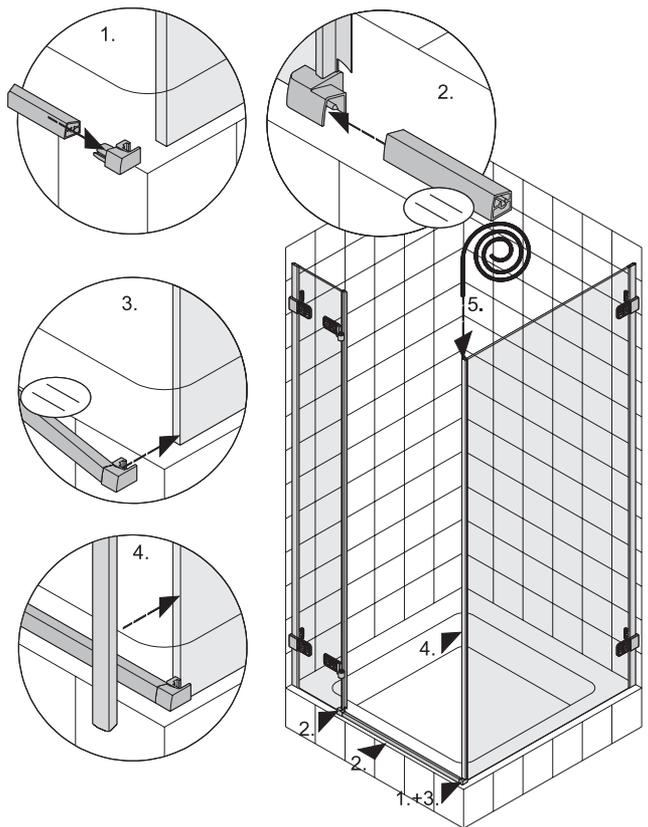
**SK** Nasuňte na spodný podlahový profil spojku profilu pre spojenie s pevnou bočnou stenou, zasuňte tento profil do spojky profilu, ktorá je namontovaná na pevnom dieli dverí a potom nasuňte na pevnú bočnú stenu. Nasaďte tesniacu lištu na pevnú bočnú stenu a nasuňte do nej magnetické tesnenie.
