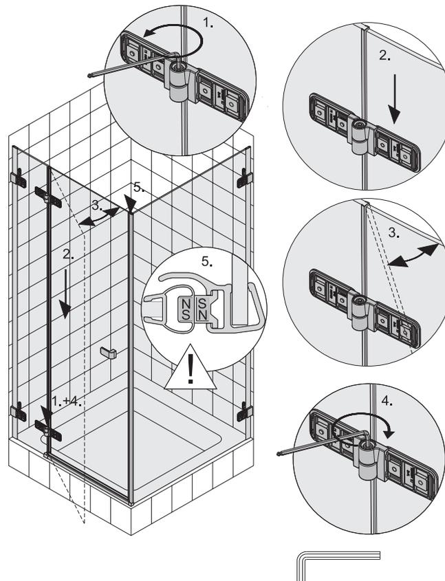
**RO** Slăbiți șuruburile de blocare de pe balamale. Asigurați-vă că părțile din dreapta și din stânga ale balamalelor se află în contact. Ajustați poziția ușilor astfel încât să vă asigurați că marginea inferioară se află la același nivel cu profilul inferior și marginea cădiței de duș și că benzile magnetice (ușă și perete) sunt în contact. Strângeți șuruburile de blocare de pe balamale inferioare, blocând astfel mecanismul de ridicare a ușii.
