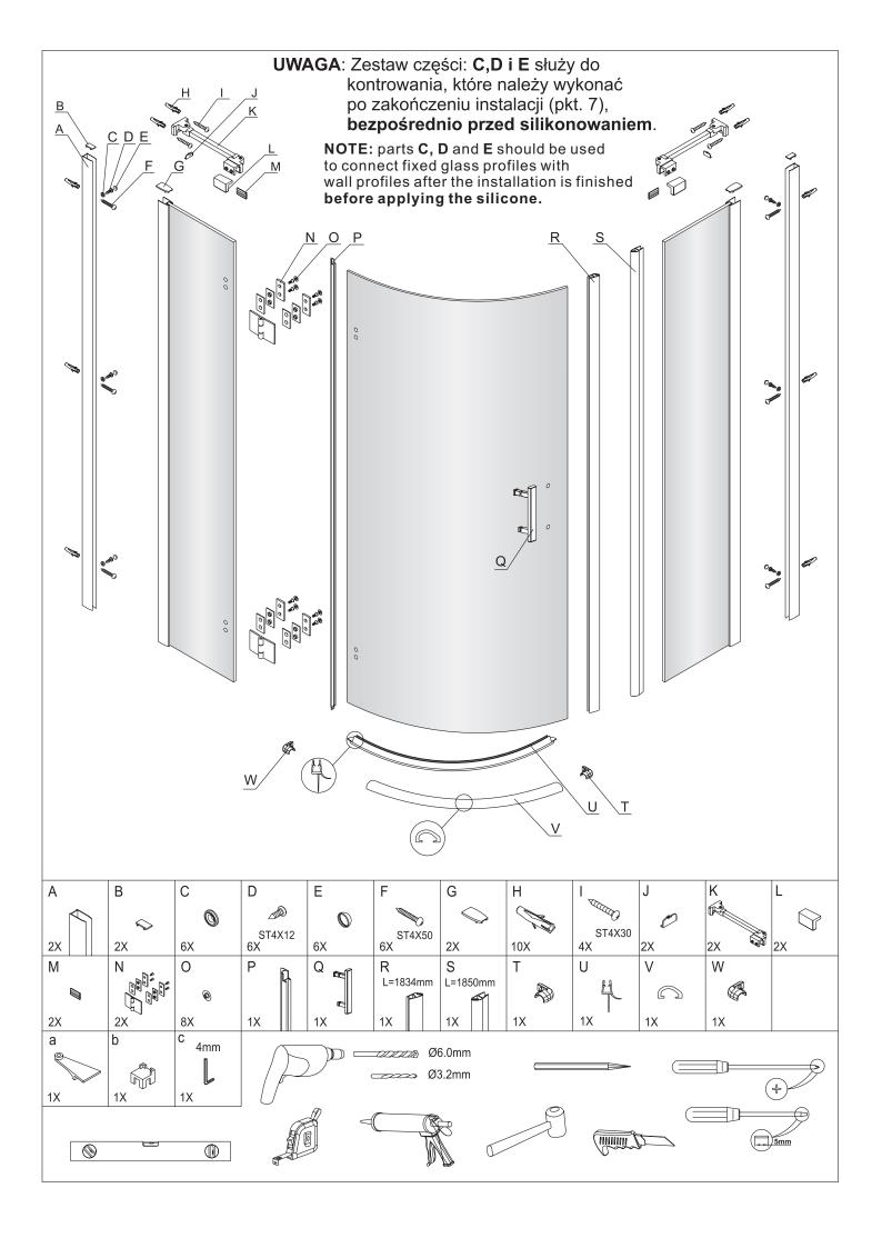
UWAGA: wymiar A i B to wymiar od rogu do zewnętrznej krawędzi profilu przyściennego - najważniejszy wymiar montażowy (profile przyścienne są maksymalnie wsunięte w profil ścianki stałej)
