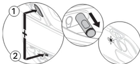
**i** Solange die blaue LED blinkt, ist das Inbetriebnahmeprogramm aktiv. Tritt ein Fehler auf, bricht das Programm nach 9 Minuten ab und die rote LED blinkt.
