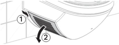
**3** Ana tuşu (1) basılı tutarak aynı zamanda ana şalteri (2) açınız. Kurutma çubuğu dışarı çıkana ve mavi LED yanıp sönmeye başlayana kadar bekleyiniz. İlk işletmeye alma programı başlar.
