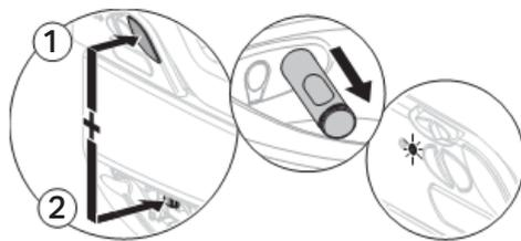
**i** Mientras parpadee el LED azul está activo el programa de puesta en marcha. Si se produce un error, el programa se interrumpe después de 9 minutos y el LED rojo parpadea.
