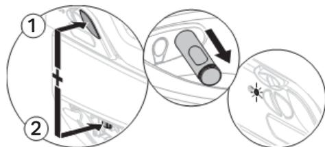
**i** Amíg az üzembe helyezési program fut, a kék LED villog. Hiba esetén a program 9 perc múlva leáll, és a piros LED-kijelző kezd el villogni.
