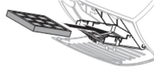
**5** Nozul temizlik malzemesinin kapağını açınız ve otomatik taharet sistemindeki doldurma gözünü çıkartınız. Şişeyi kaldırınız ve döndürünüz. Nozul temizlik malzemesi otomatik olarak depoya akar. Şişeyi bastırmayınız, aksi halde nozul temizlik malzemesi yana sıçrayabilir.
