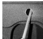
Ilustracja 5 Kształt otworu końcowego powstaje na skutek wyszlifowania go zdzierakiem.
