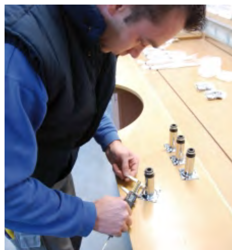
Aquaform - kontrola nóżek meblowych
